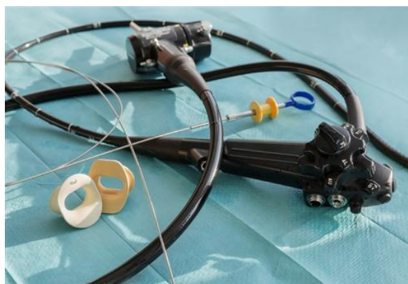
Slika 6. Endoskopski fleksibilni gastroskop.
