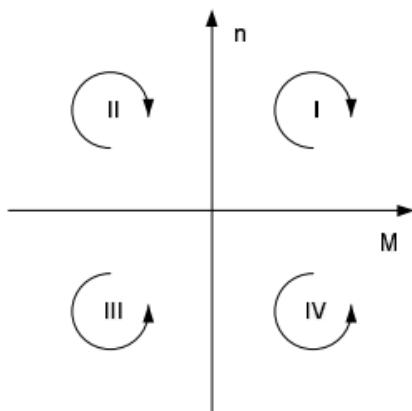
Slika 2 Četiri režima rada elektromotornog pogona
