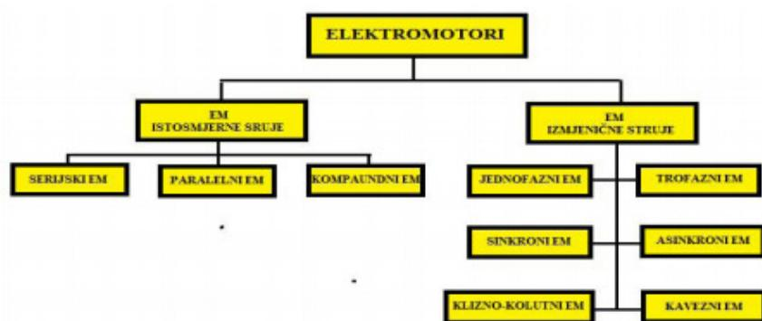
Slika 3 Osnovna podjela elektromotora
