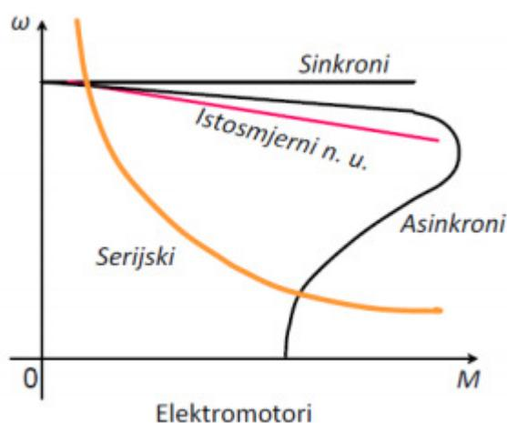
Slika 1 Vrste elektromotora
