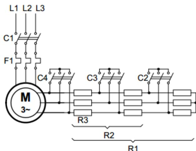
Slika 12 Kolutni asinkroni elektromotor
