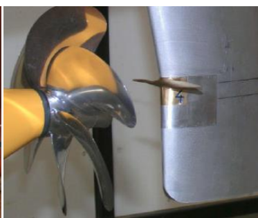
Slika 36. HHI Thrust Fins (ABS)
