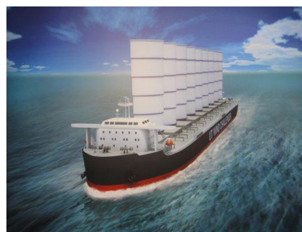
Slika 45. Teretni brod opremljen čvrstim jedrima, (IWSA)
