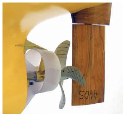
Slika 41. ModelBMS Mewis Duct®- ABS
