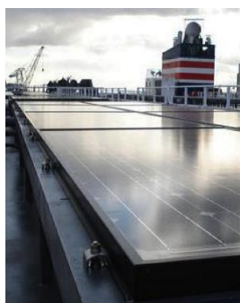
Slika 48. Solarni paneli na NYK's Auriga Leader
