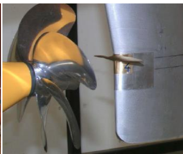
Slika 36. HHI Thrust Fins (ABS)
