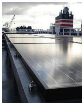
Slika 48. Solarni paneli na NYK's Auriga Leader
