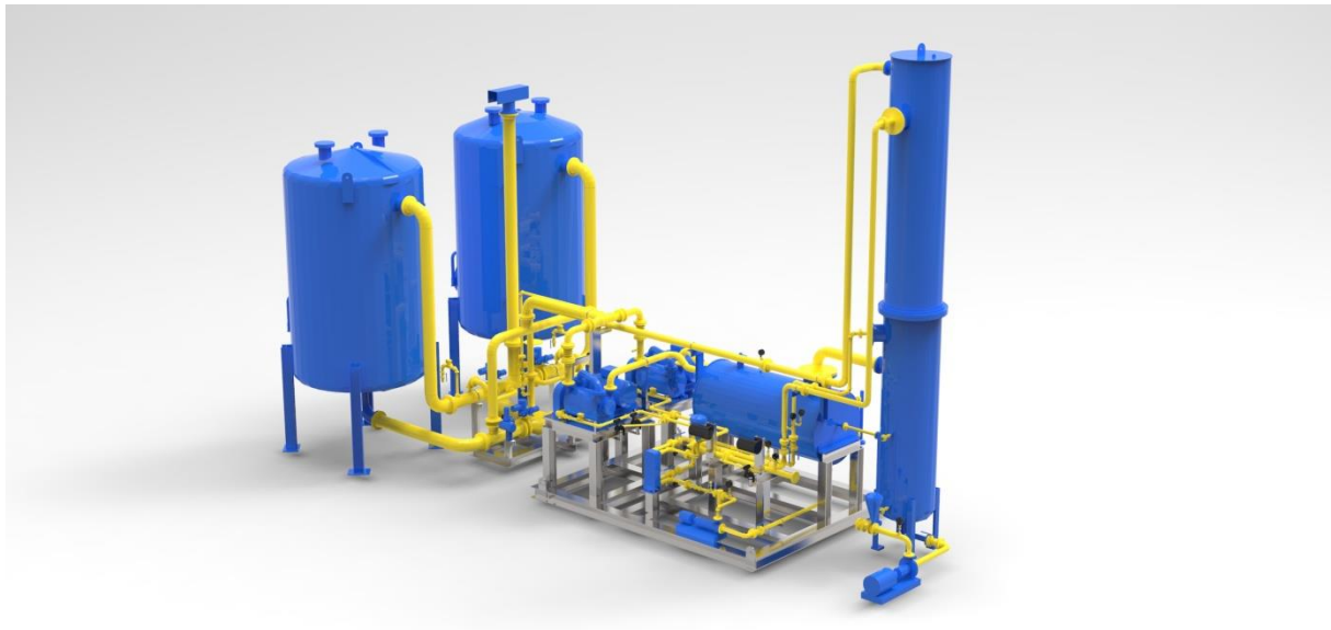
Slika 16. Sustav za obradu ugljikovodičnih para prikazan u GrabCadu
