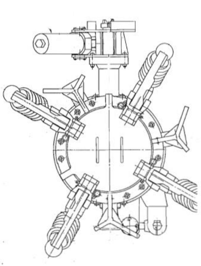
Slika 11. Nacrt M.I.B. kandže na hidrauličnoj spojki u terminalu Omišalj
