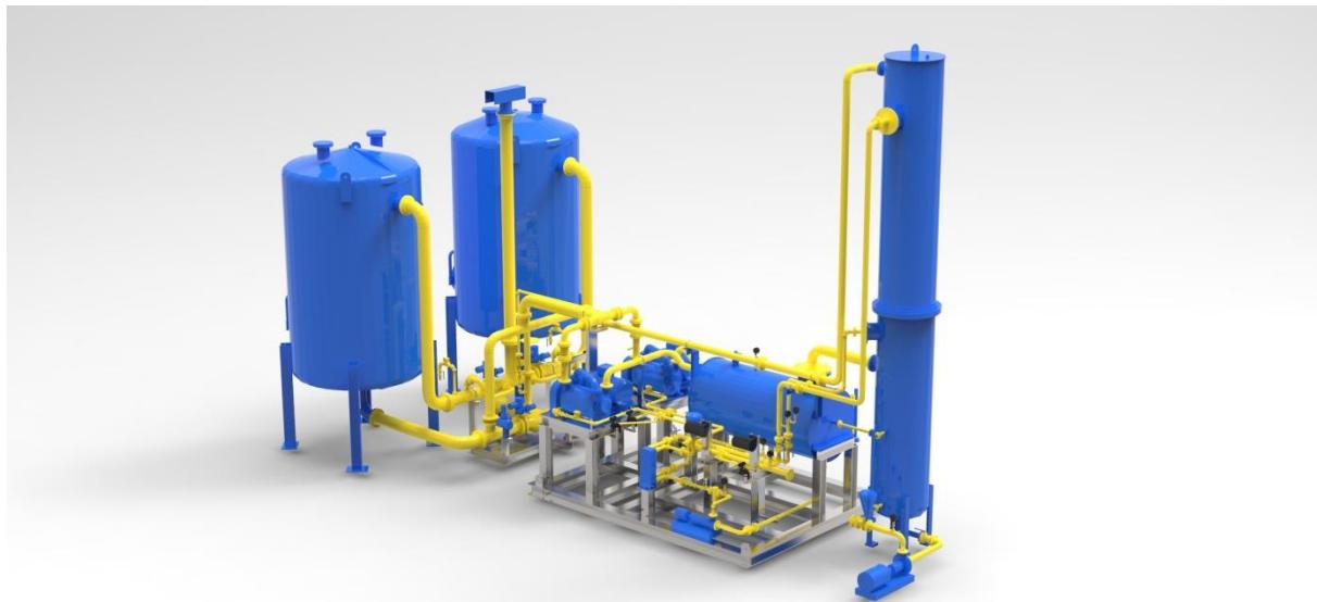
Slika 16. Sustav za obradu ugljikovodičnih para prikazan u GrabCadu
