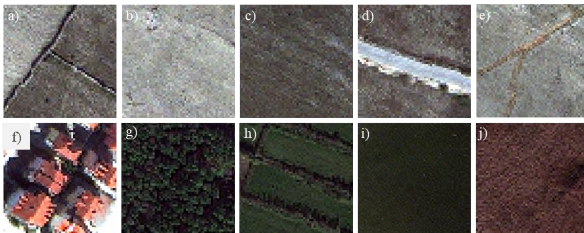
Slika 48. GEOBIA klase (MS WV-2 2016): a) suhozidi, b) krš, c) travnjaci, d) široki put, e) uski put, f) objekti, g) šuma, h) zelene ograde, i) voda, j) trstika
