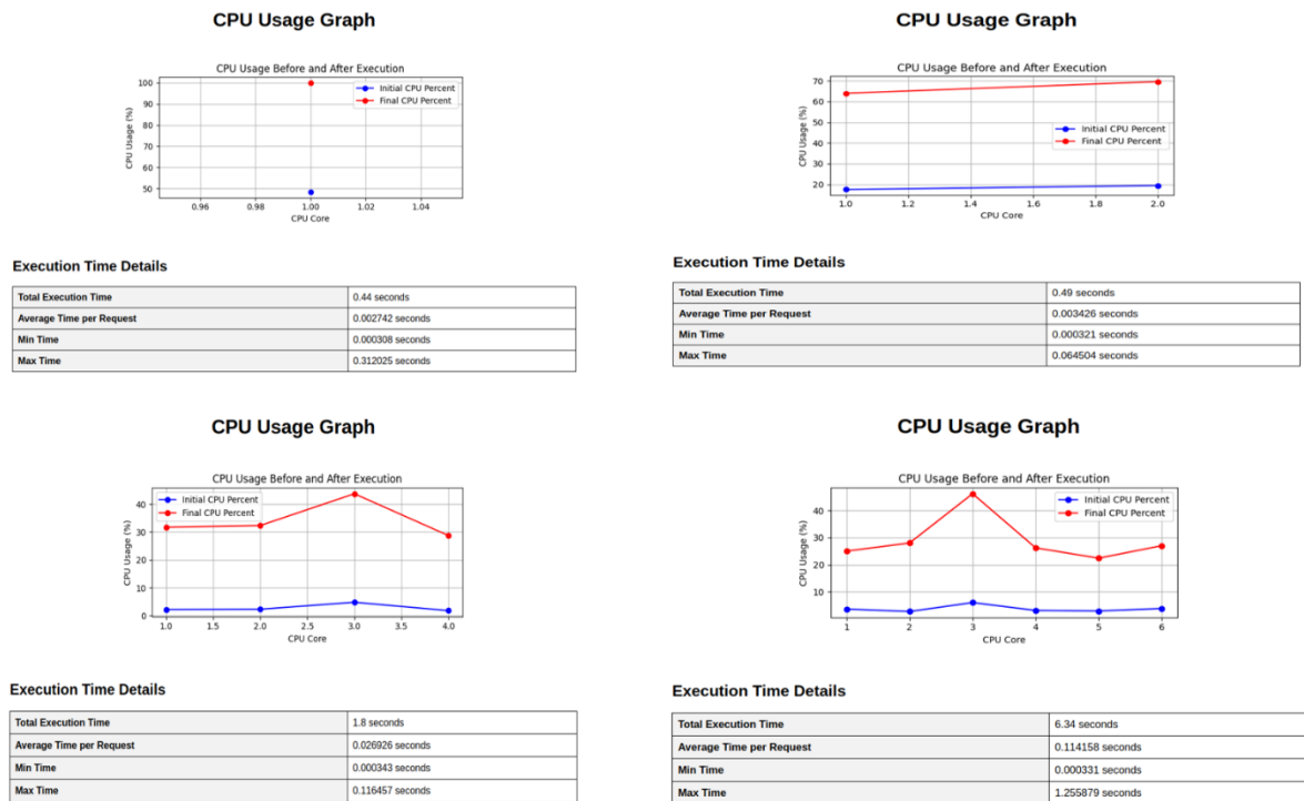
Slika 7. Grafovi opterećenja procesora: 1, 2, 4, 6 jezgri
