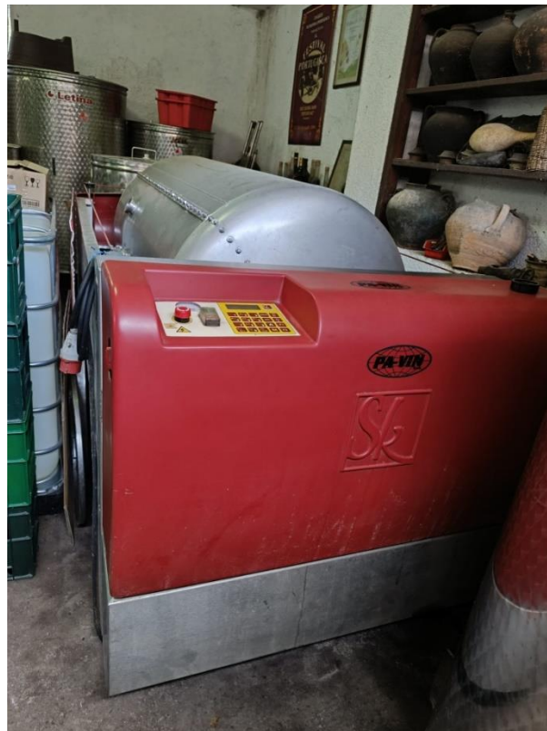
Prilog 7. Fotografija prikazuje pneumatsku prešu za preradu grožđa. Helena Severinac. Vinarski podrum Jurkovac , 2024.
