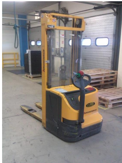
Slika 7. Visokopodizni ručni viličar
