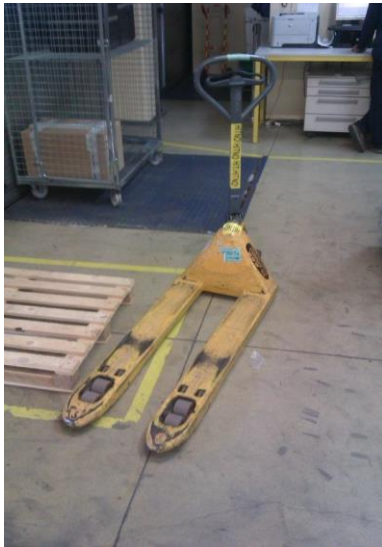
Slika 6. Ručni niskopodizni viličar
