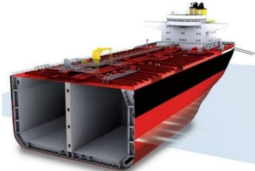
Slika 3. Primjer konstrukcije s dvostrukim trupom
