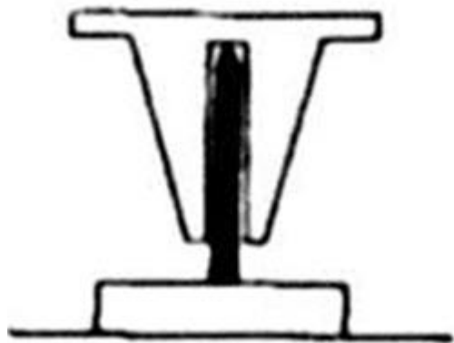
Slika 20. Lončarsko kolo na ručni pogon.
