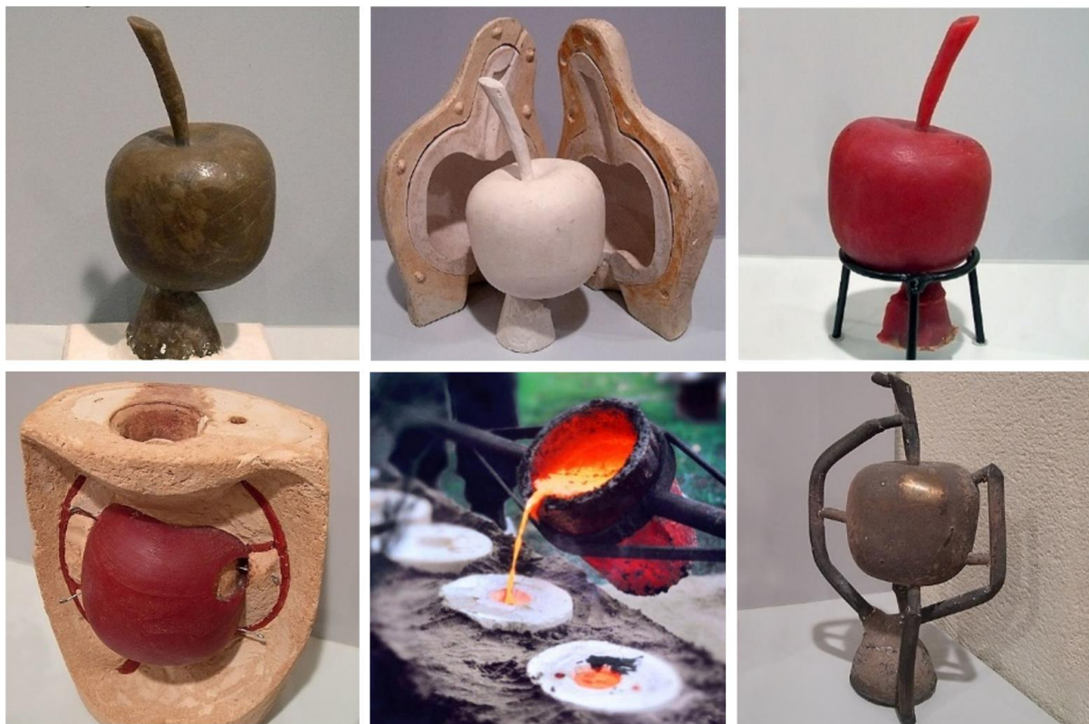
Slika 29. Prikaz metode izgubljenog voska.
