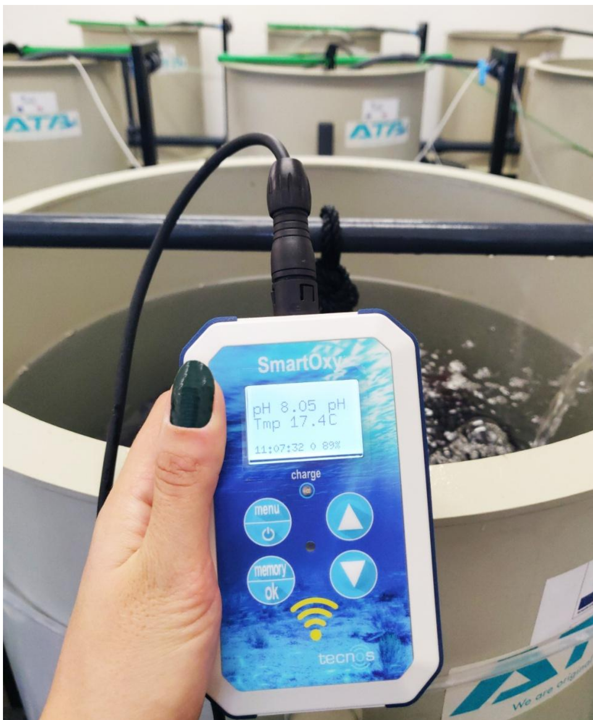
Slika 11. SmartyOxy prijenosni oksimetar s priključenom sondom za pH (Autor: Marija Brkić)
