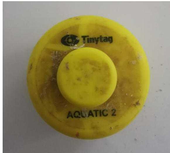
Slika 11. Data logger korišten za mjerenje temperature mora na lokacijama istraživanja (Izvor: Perović N.)
