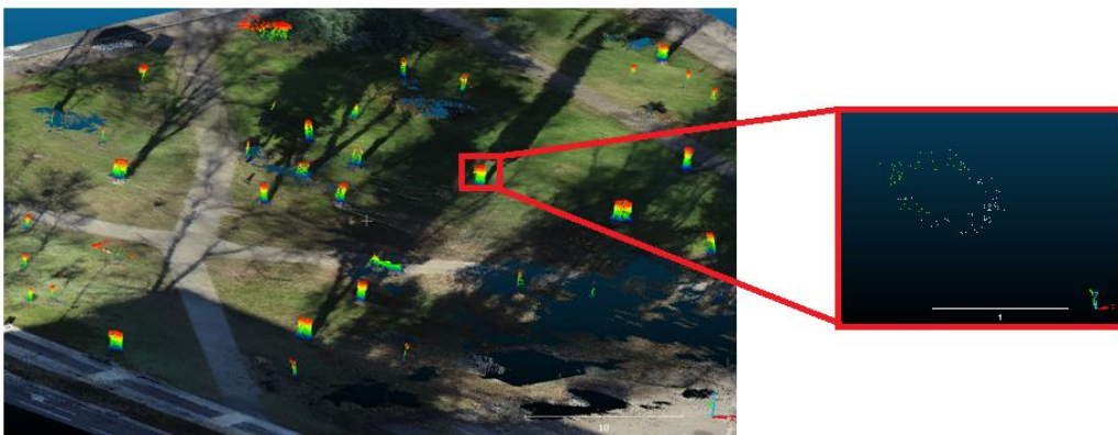
Slika 42. Presjek stabla i sloj od 10 cm
