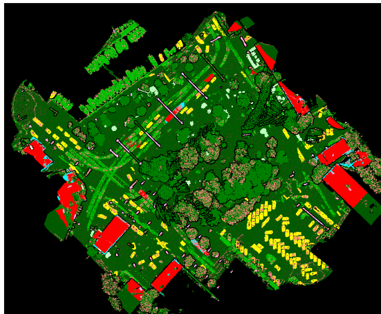
Slika 23. Klasificirani oblak točaka dobiven automatskom klasifikacijom
