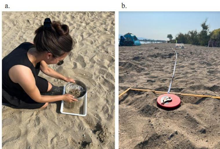
Slika 4. Prosijavanje sedimenta i određivanje udaljenosti između replika
