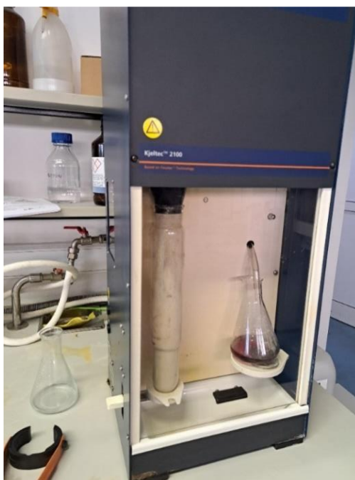
Slika 4. Aparat za destilaciju (Izvor: Autor)
