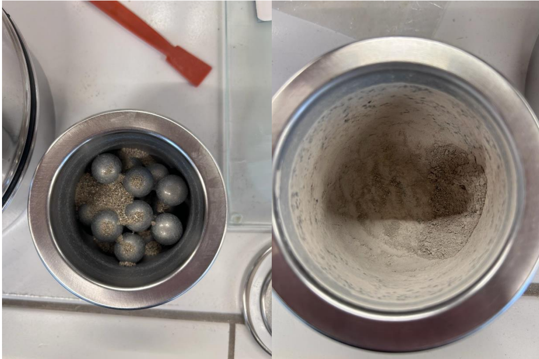
Slika 28. Uzorak prije i nakon mljevenja (izvor: autor)
