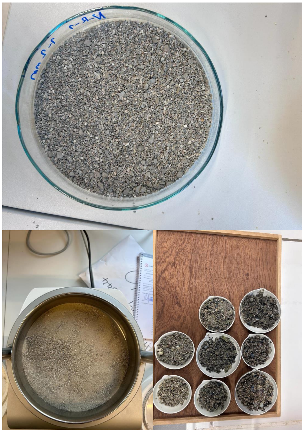
Slika 21. Uzorak od 1 mm do 2 mm (gore), uzorak manji od 1 mm (lijevo) i uzorak veći od 2 mm (desno). (izvor: autor)
