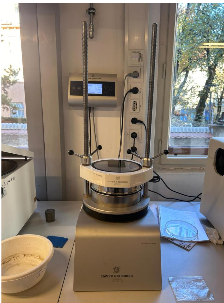
Slika 20. Stroj za analitičko sito Haver & Boecker EML 200 premium. (izvor: autor)
