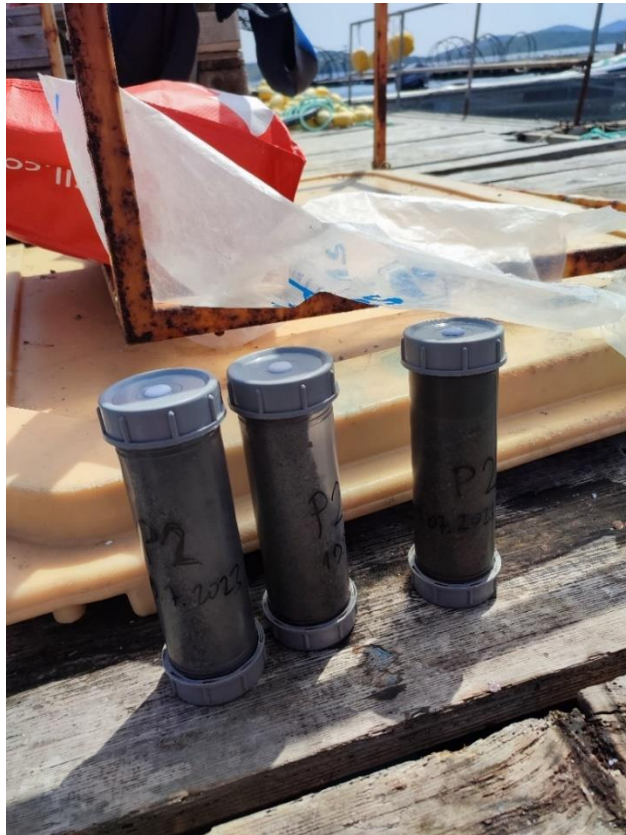
Slika 8. Tuljci s prikupljenim sedimentom za uzorkovanje (L2). (izvor: autor)
