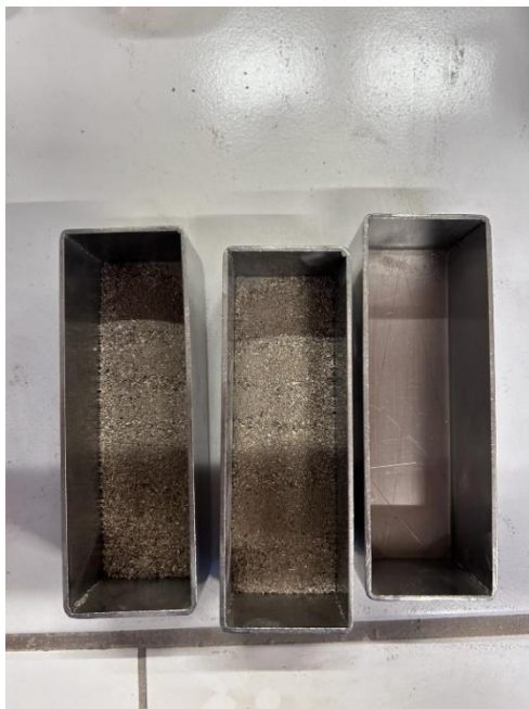
Slika 25. Homogenizacija uzorka vršila se uvijek nasumičnim odabiranjem posuda. (izvor: autor)
