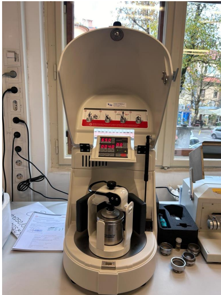
Slika 27. Planetarni mono mlin Fritsch PULVERISETTE 6. (izvor: autor)
