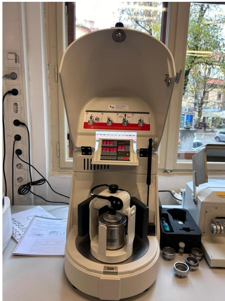
Slika 27. Planetarni mono mlin Fritsch PULVERISETTE 6. (izvor: autor)
