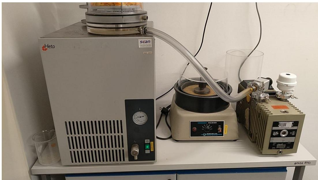
Slika 16. Liofilizator (HETO Freeze-Dryer) (lijevo) spojen na vakuumsku pumpu (desno).
