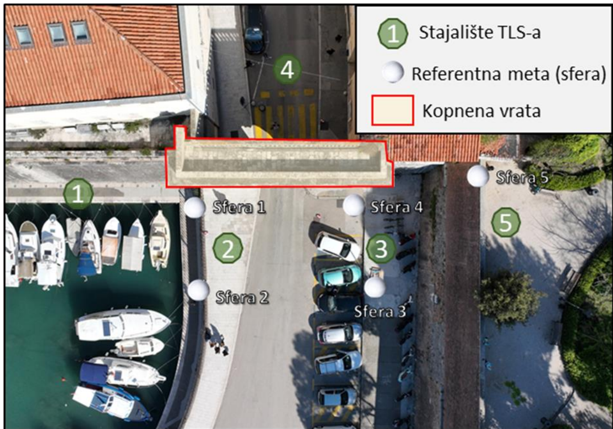
Slika 22. Plan skeniranja TLS-om
