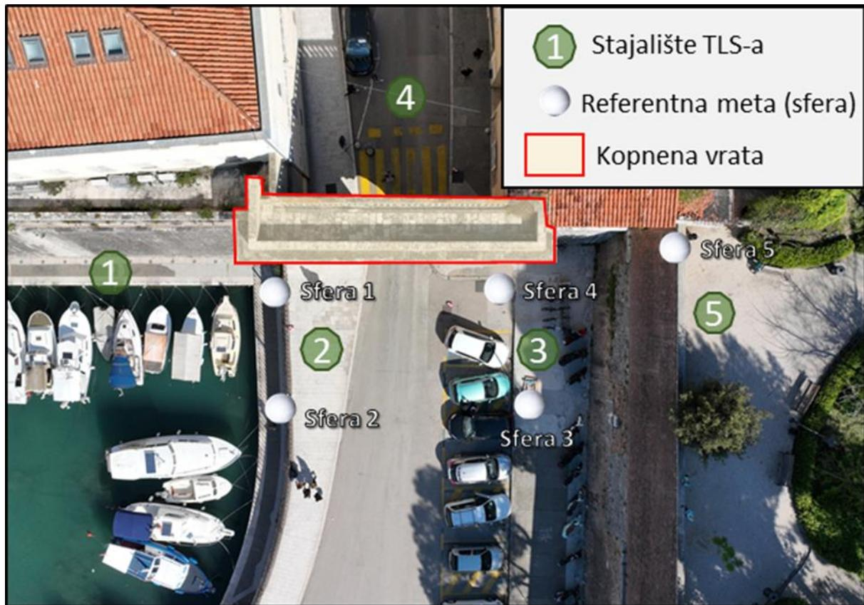
Slika 22. Plan skeniranja TLS-om
