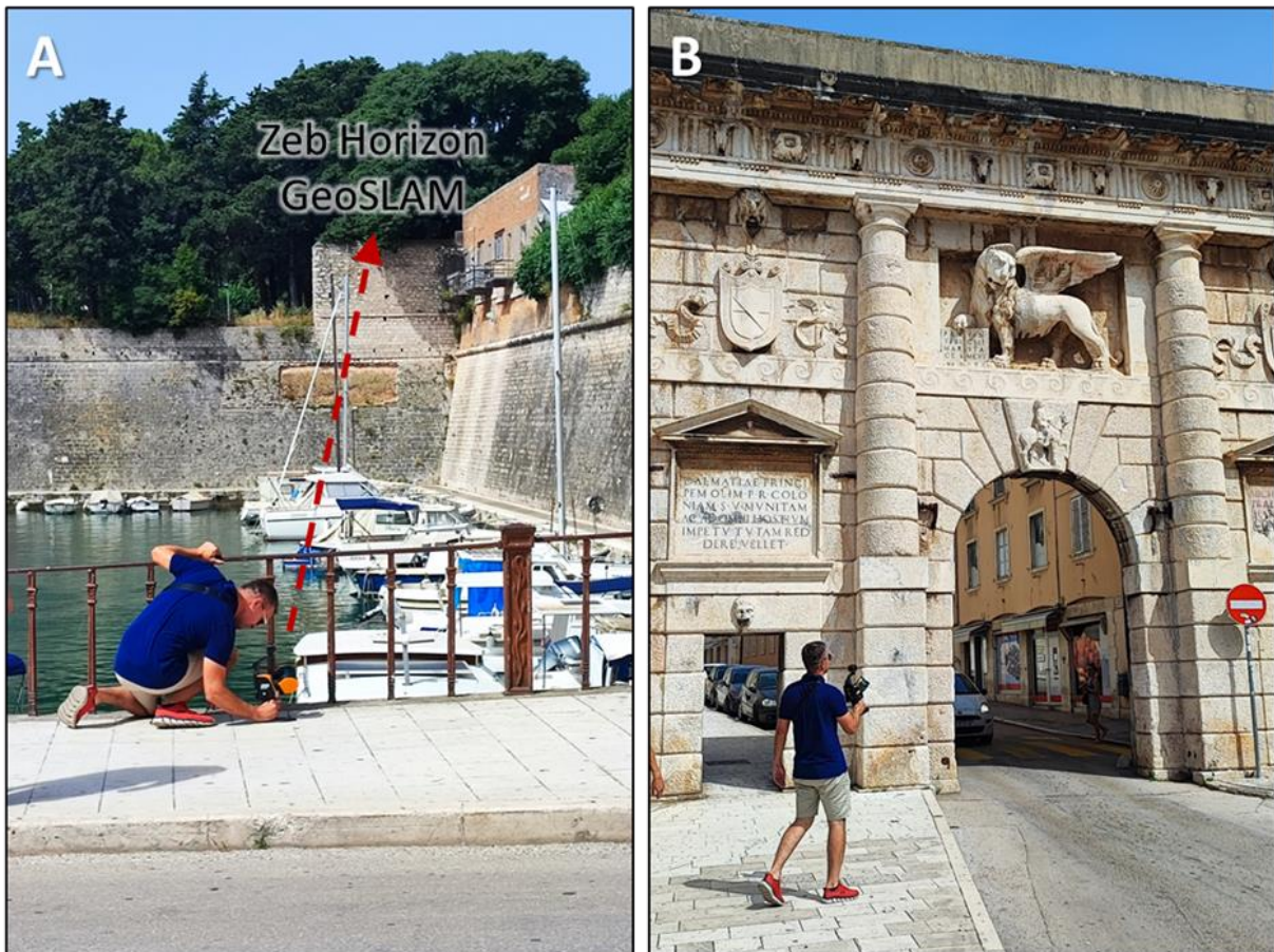
Slika 25. Terensko snimanje Kopnenih vrata ZEB Horizon GeoSLAM-om (A – inicijalizacija ZEB Horizon GeoSLAM-a; B – proces mobilnog skeniranja Kopnenih vrata)
