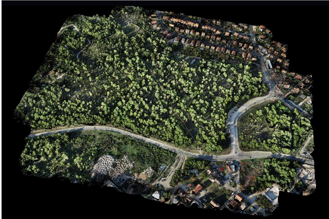
Slika 19 Gusti oblak točaka u softveru DJI Terra
