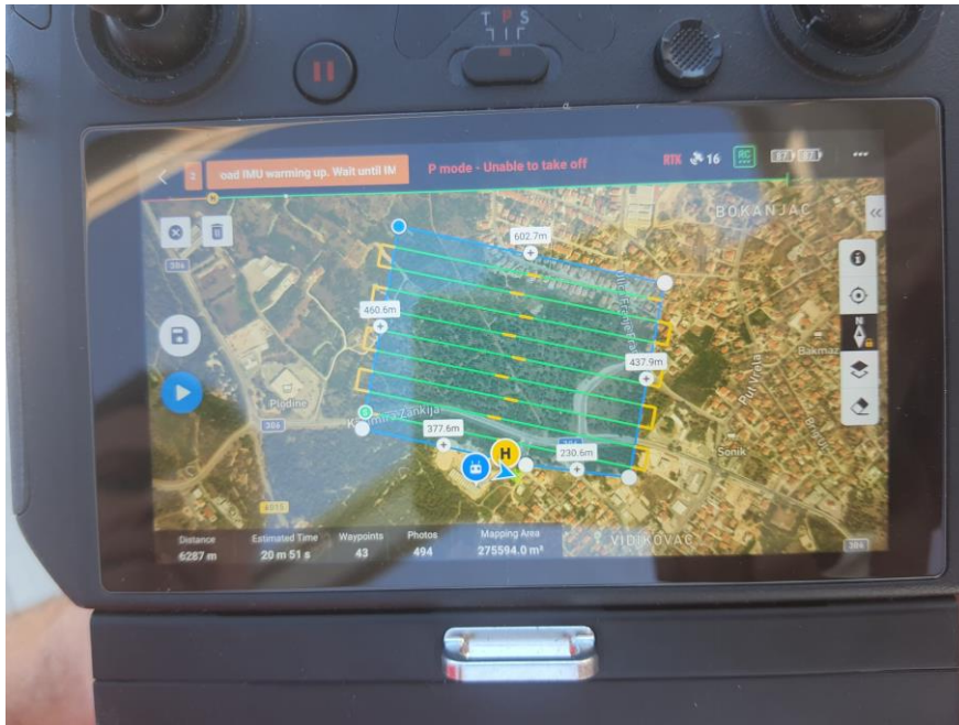
Slika 12 Misija sjever-jug prikazana na kontroloru bespilotne letjelice
