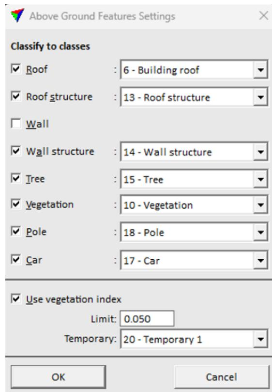
Slika 33 Classify Above Ground Features i postavljeni parametri
