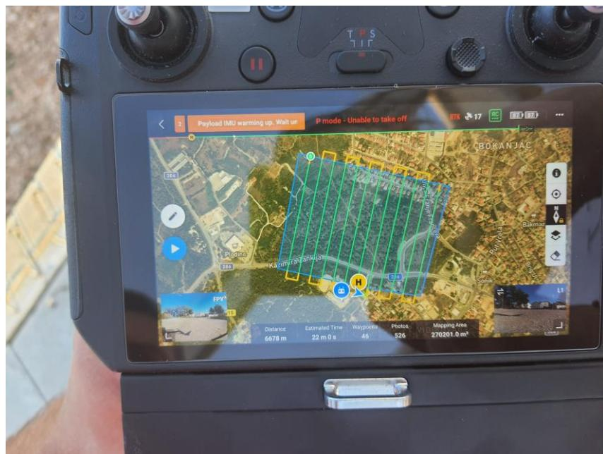
Slika 13 Misija istok-zapad prikazana na kontroloru bespilotne letjelice
