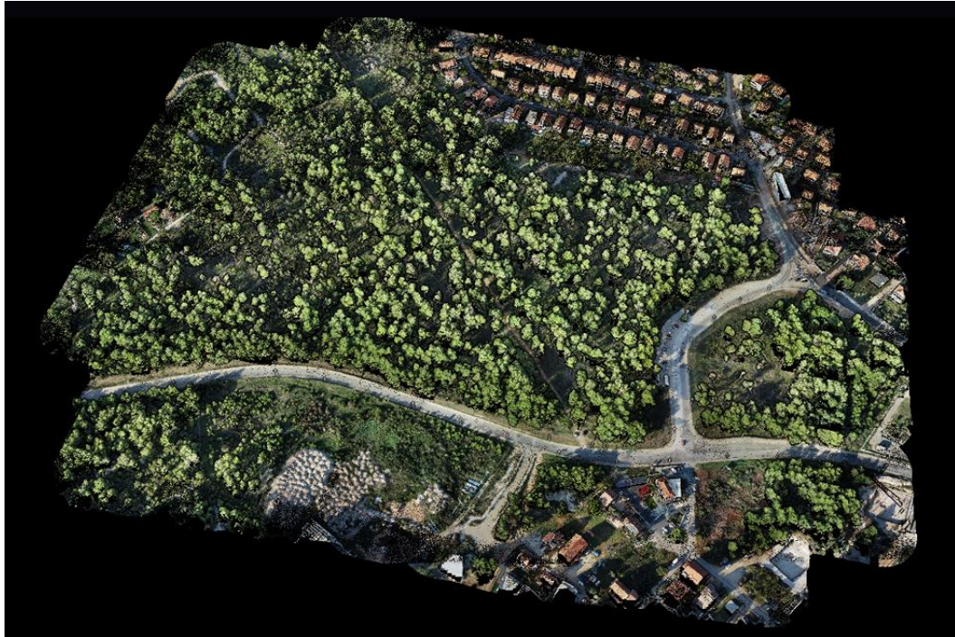
Slika 19 Gusti oblak točaka u softveru DJI Terra
