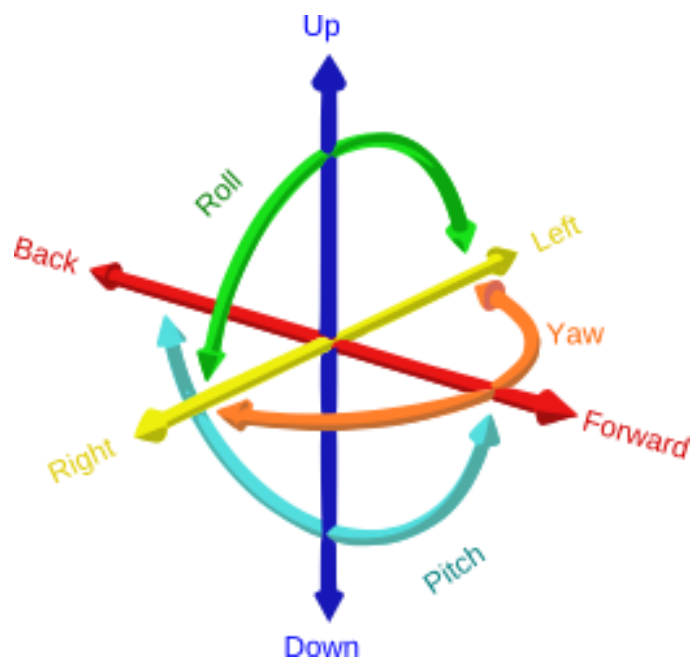
Slika 4 Šest stupnjeva slobode - 6DoF (URL4)
