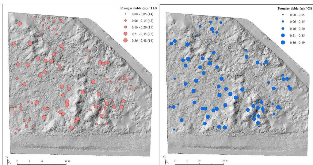
Slika 68 Promjer debla stabala dobiven TLS-om i GeoSLAM-om
