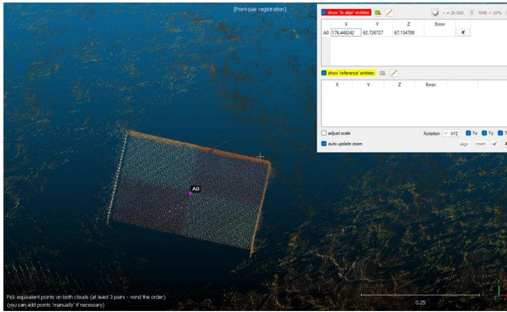
Slika 40 Orijentacijska točka na gustom oblaku točaka TLS-a u softveru Cloud Compare
