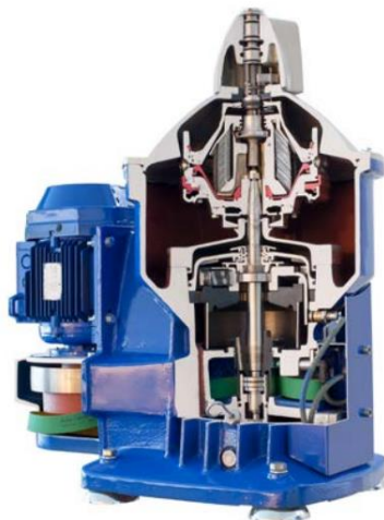
Slika 5. Presjek centrifugalnog separatora (izvor: Alfa Laval- Service by exchange)
