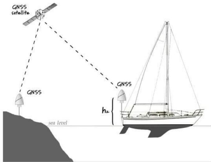
Slika 9. Princip rada (D)GNSS-a [9]
