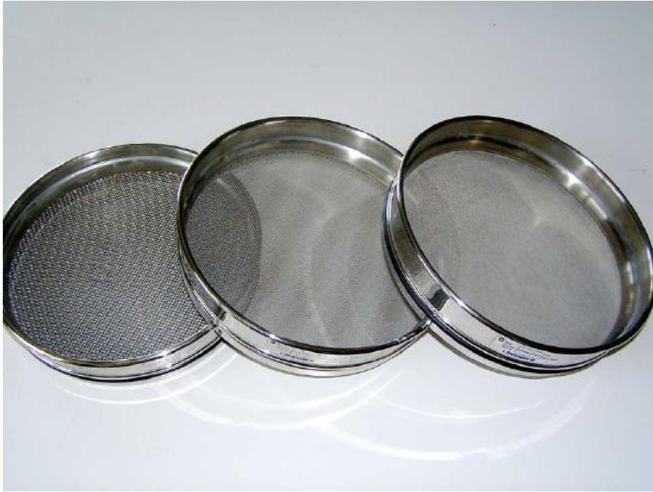
Slika 8. Metalna sita korištena za sortiranje čestica različitih promjera (izvor: Internetska stranica ChemistryLibreTexts)
