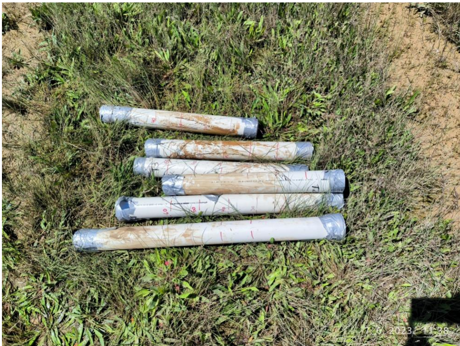
Slika 9. Koreri (PVC cijevi) korištene za uzorkovanje sedimenta (Izvor: vlastita fotografija)
