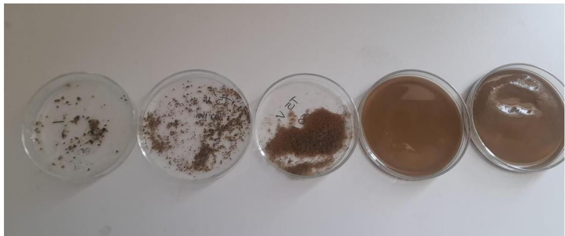
**Slika 12.** Uzorak T5 V ( točka 5 vrh), s lijeva na desno frakcije: 1 mm, 500 µm, 250 µm, 125 µm i 63 µm (Izvor: vlastita fotografija)
