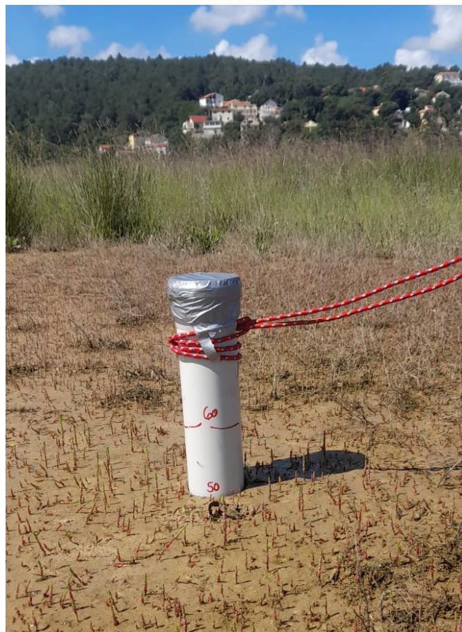
Slika 7. Zabijeni korer u tlo (Izvor: vlastita fotografija)
