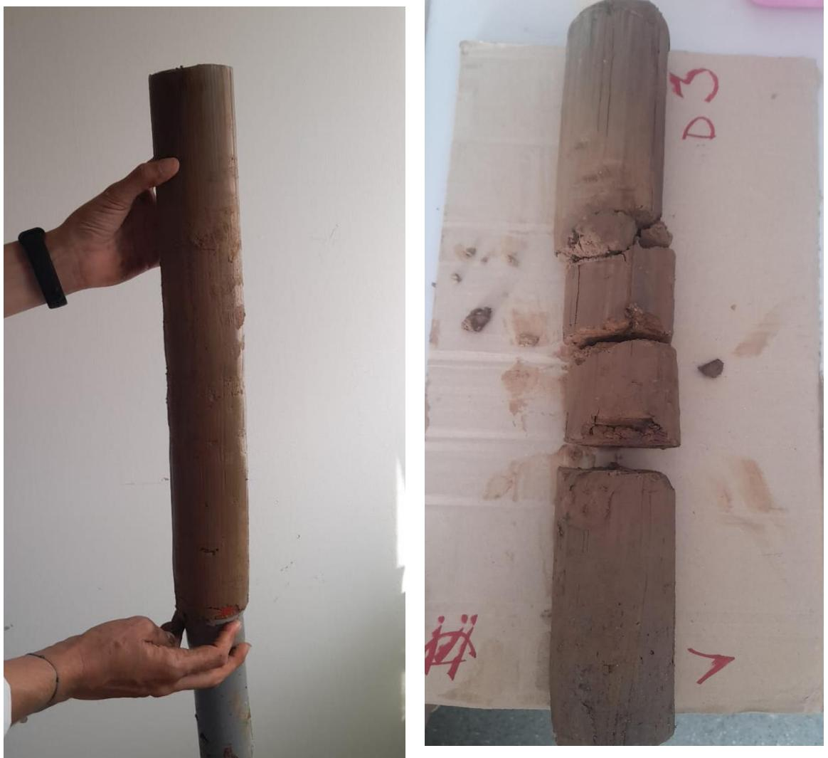
**Slika 10.** Prikaz izvlačenja uzorka iz korera (Izvor: vlastita fotografija)
