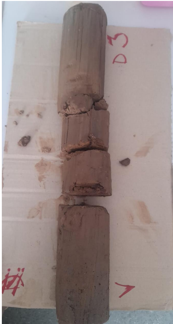
Slika 10. Prikaz izvlačenja uzorka iz korera (Izvor: vlastita fotografija)
