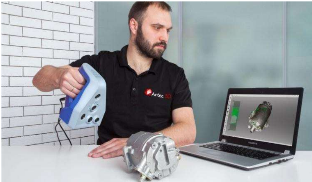
Slika 5. Generiranje modela korištenjem ručnog skenera (URL16)
