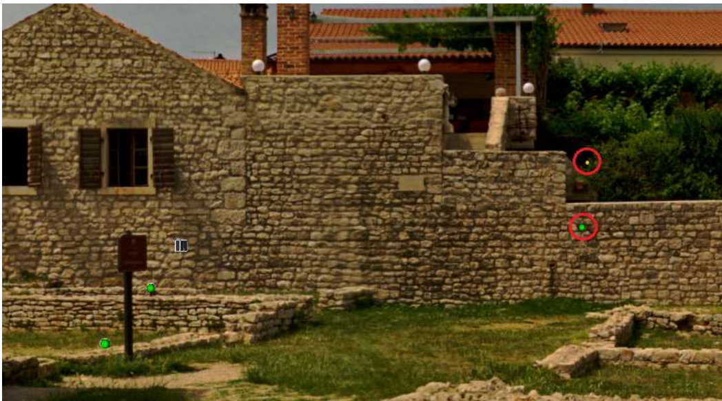
Slika 30. Točke koje je SCENE označio kao referentne
