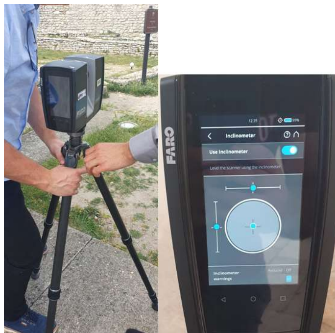
Slika 23. Postavljanje i kalibracija uređaja Faro Focus m 70
