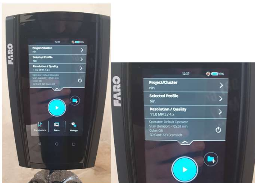
Slika 22. Sučelje s postavkama skeniranja na uređaju Faro Focus m 70
