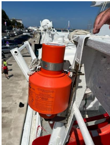
Slika 1. MOB svjetlosni i dimni signal koluta za spašavanje
