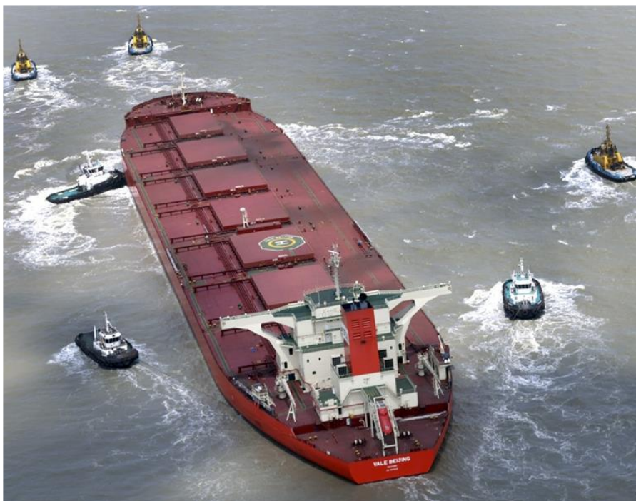
Slika 11. Pozicioniranje tegljača prije prihvata Izvor: The nautical Institute, The Shiplander's guide, 2015.
