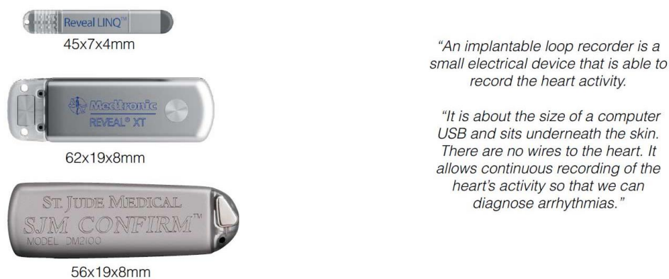
Slika 6. Implatabilni snimač ritma srca
