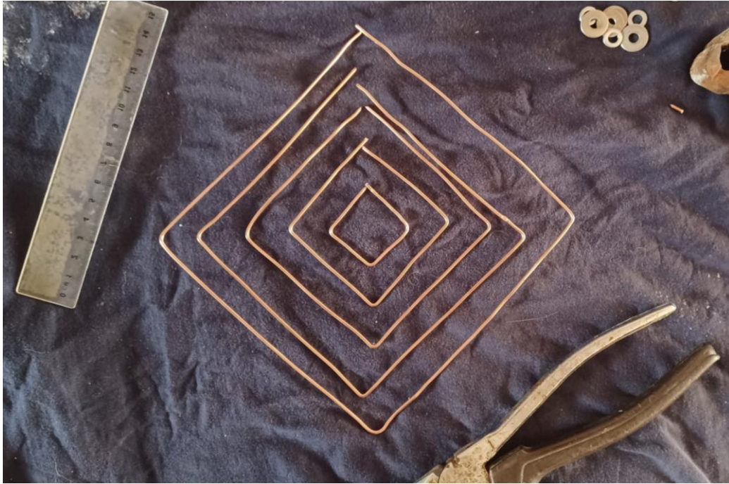
Slika 27. Bakrena žica savijena pod pravim kutom u različitim dužinama u obliku kvadrata
