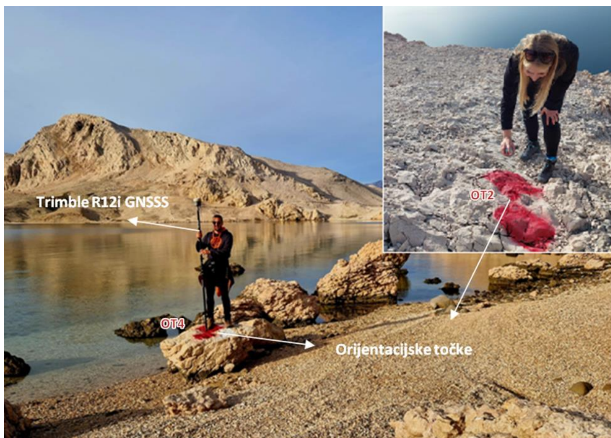
Slika 20. Označavanje i prikupljanje orijentacijskih točaka
