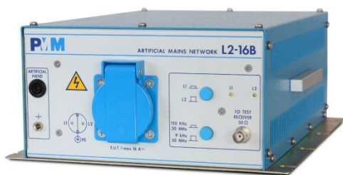
Slika 6 Mjerenje impedancije voda
