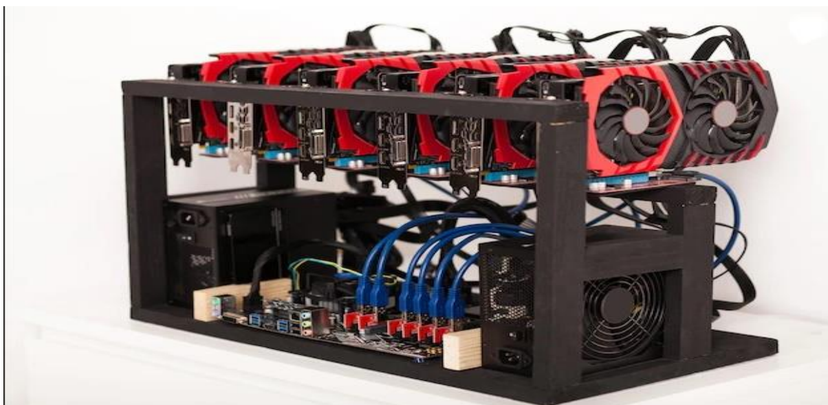
Slika 5: Platforma za „rudarenje“ putem grafičkih procesorskih jedinica
