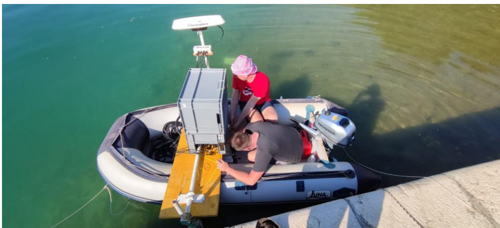
Slika 31. Gumenjak Luna s instaliranim integralnim mjernim sustavom
