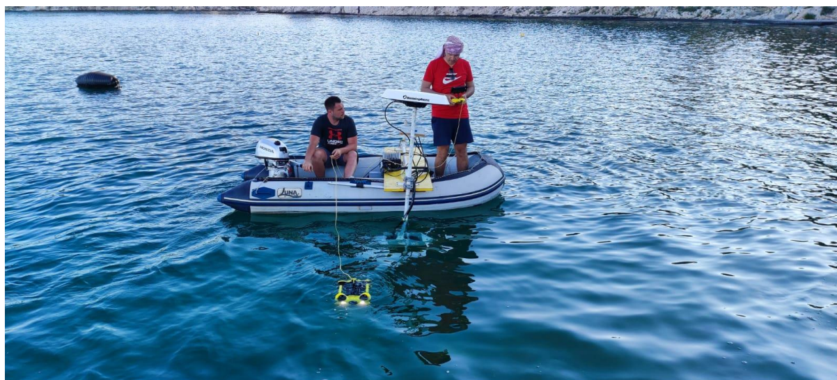
Slika 41. Korištenje podvodne bespilotne ronilice Chasing M2 prilikom kartiranja morskog otpada unutar odabrane testne plohe
