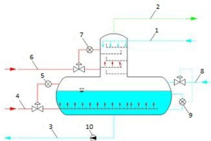
**Slika 7.** Prikaz otpolinjača sa spremnikom napojne vode [23].
