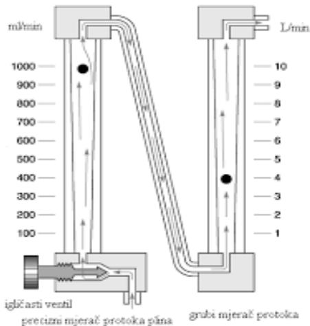
**Slika 5.** Shematski prikaz mjerača protoka i igličastog ventila (1)
