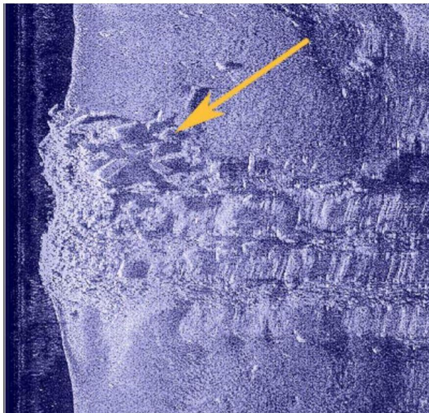
Slika 10. Snimka kamenih blokova rimskog mosta u Osijeku generirana iz podataka prikupljenih bočnoskenirajućim sonarom
