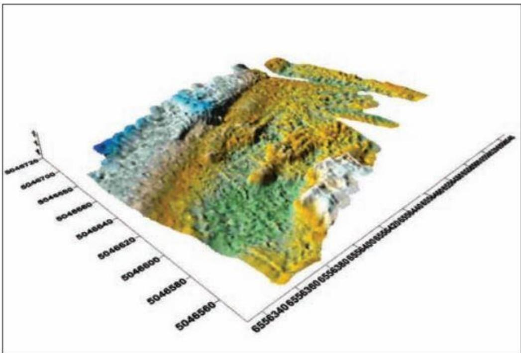
Slika 6. Primjer dobivene snimke generirane preko podataka višesnognog dubinomjera; na slici su ostaci triju pronađenih stupova na lokaciji rimskog mosta u Osijeku prilikom istraživanja 2009. godine (K. ZUBČIĆ, 2010, 35.).
