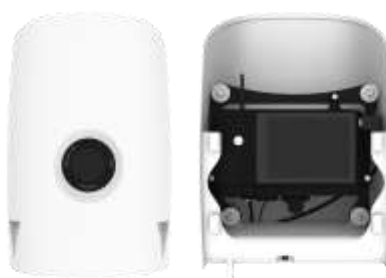
Slika 7. Sony RX1R II fotoaparata u kućištu spremnom za postavljanje na bespilotnu letjelicu (URL8)
