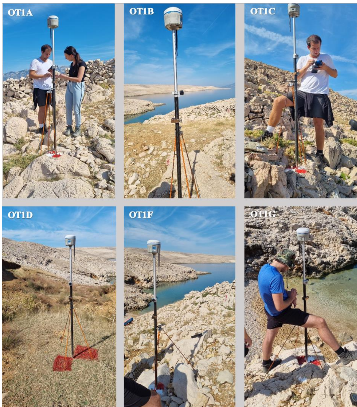
Slika 25. Prikupljanje OT-a i CP-a koristeći STONEX S10 GNSS
