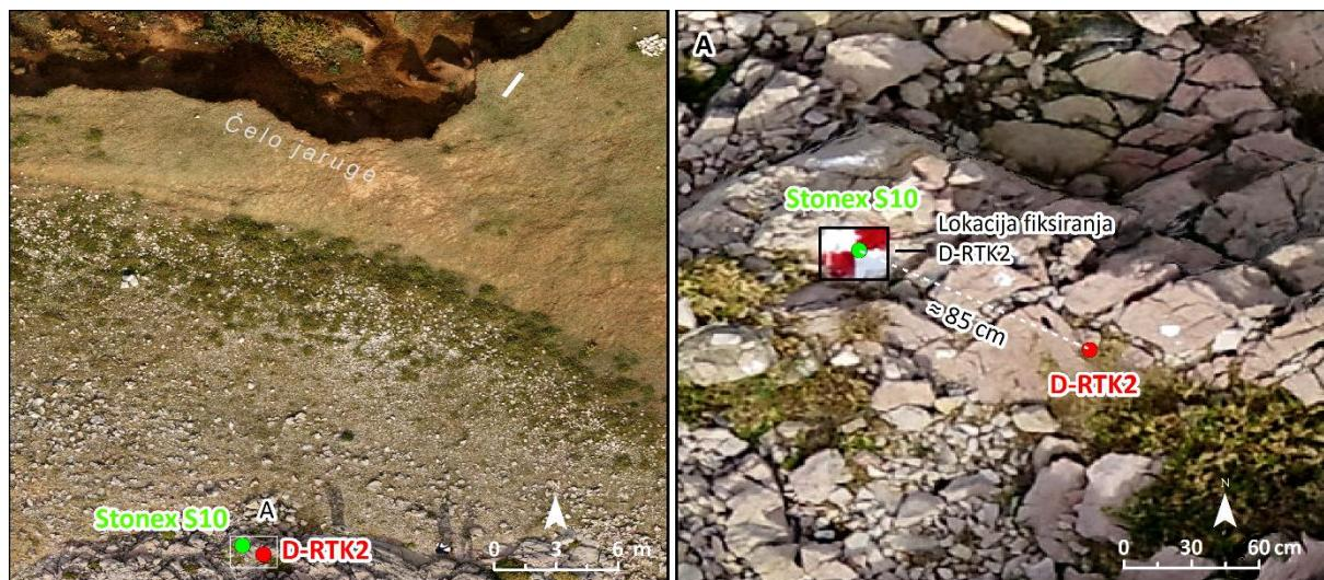
Slika 16. Geokodirana razlika u lokaciji fiksirane mobilne stanice D-RTK 2 očitane pomoću Stonexa S10 i D-RTK 2 (podloga DOF izveden koristeći 10 OT-a)
