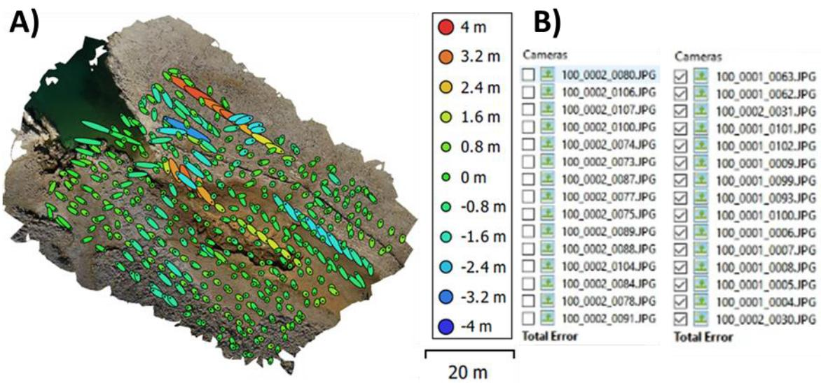
Slika 31. (A) Procijenjena pogreška pozicioniranja kamera; (B) (ne)korištenje XYZ koordinata fotografija u orientaciji modela
