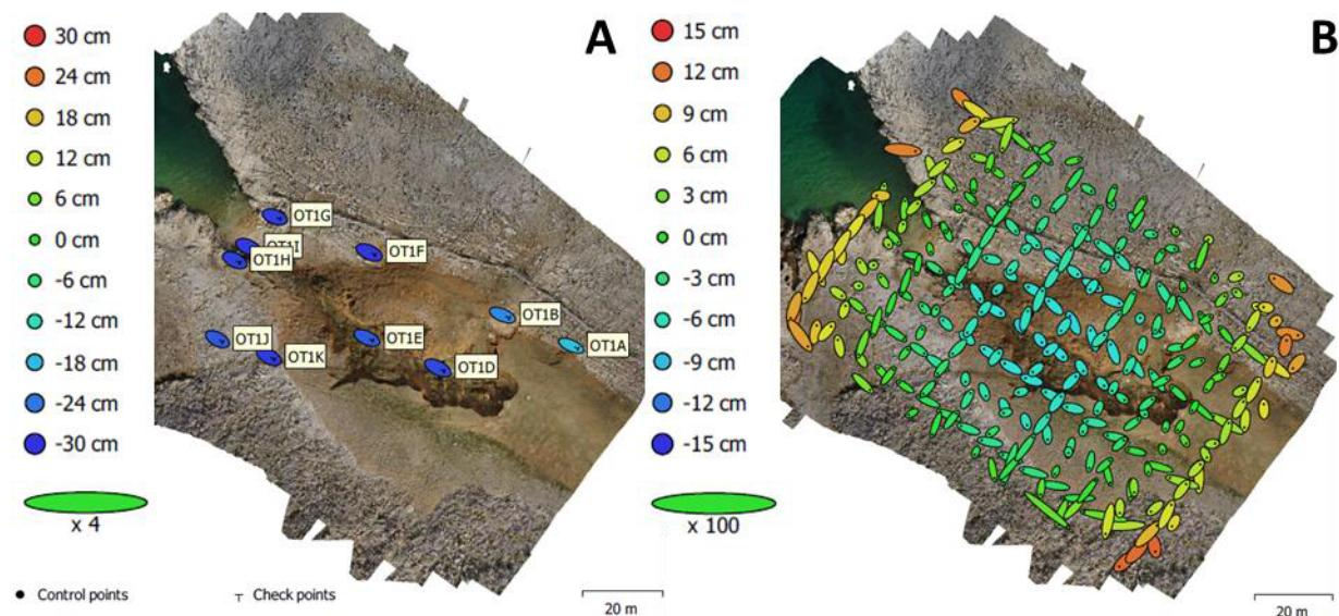
Slika 33. (A) Lokacija i pogreške OT-a; (B) procijenjene pogreške pozicioniranja kamere
