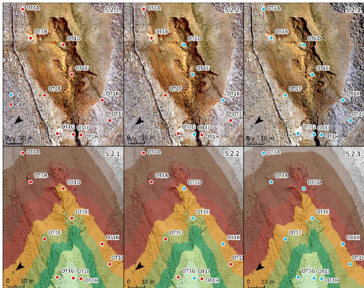
Slika 32. DOF-ovi i DEM-ovi izvedeni klasičnim pristupima (5.2.1., 5.2.2, i 5.2.3)
