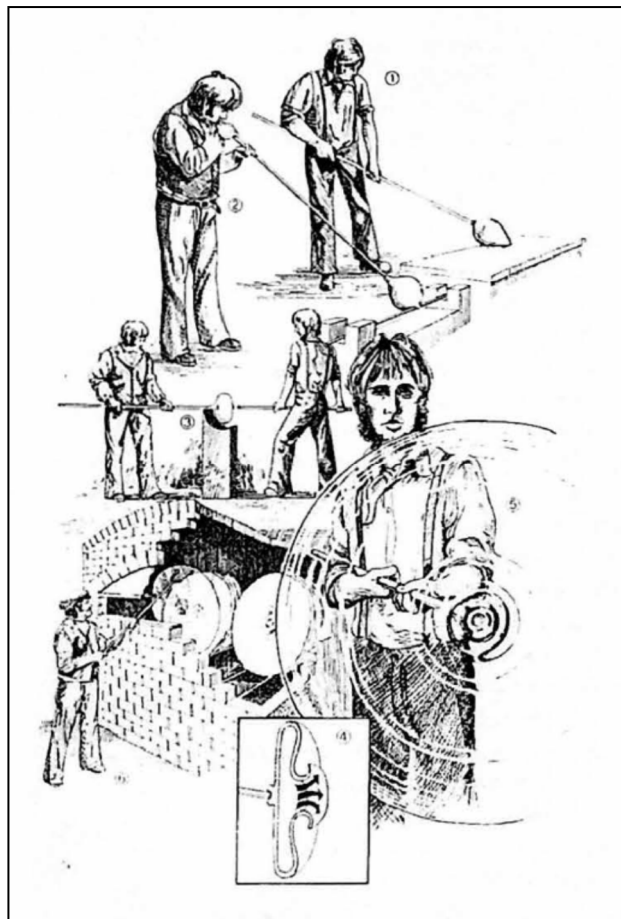
Slika 81. Proces proizvodnje ocula (D. STIAFFINI, 1999., Fig 134)
