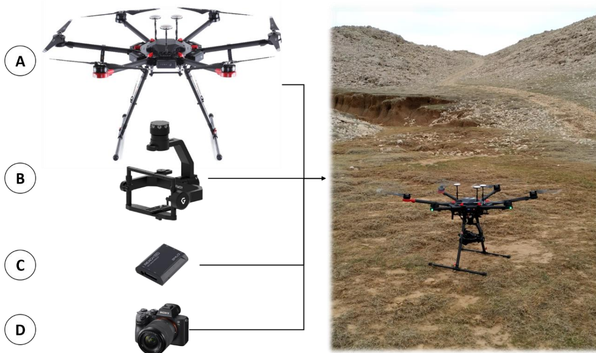
Slika 58. Komponente razvijenog RAPS-a ( lijevo ); primjena RAPS-a za aerofotogrametrijsko snimanje jaruge ( desno )
