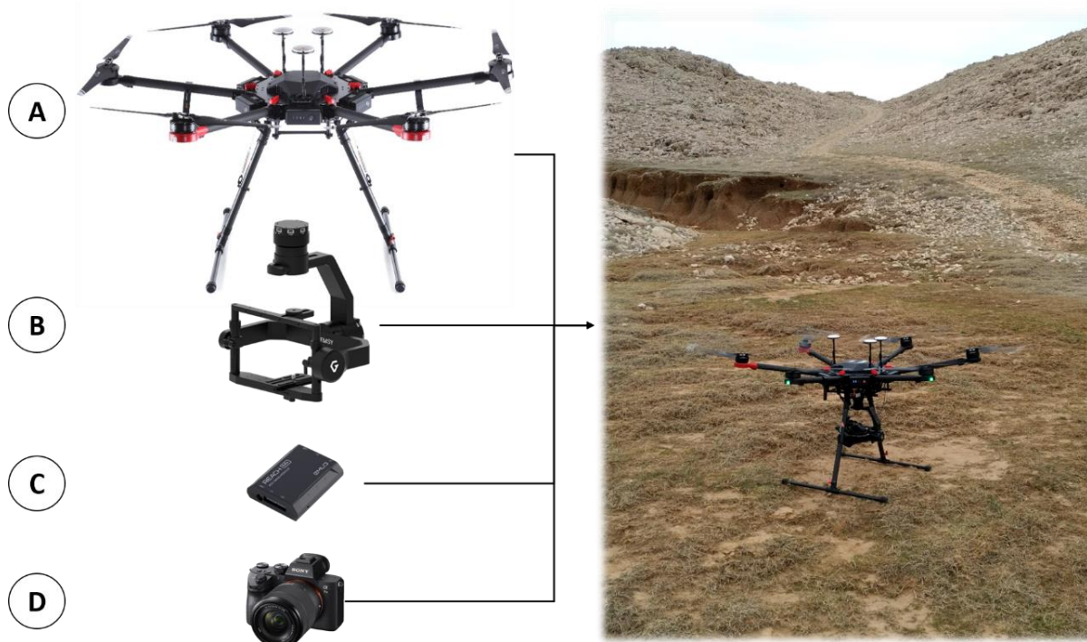
Slika 58. Komponente razvijenog RAPS-a ( lijevo ); primjena RAPS-a za aerofotogrametrijsko snimanje jaruge ( desno )
