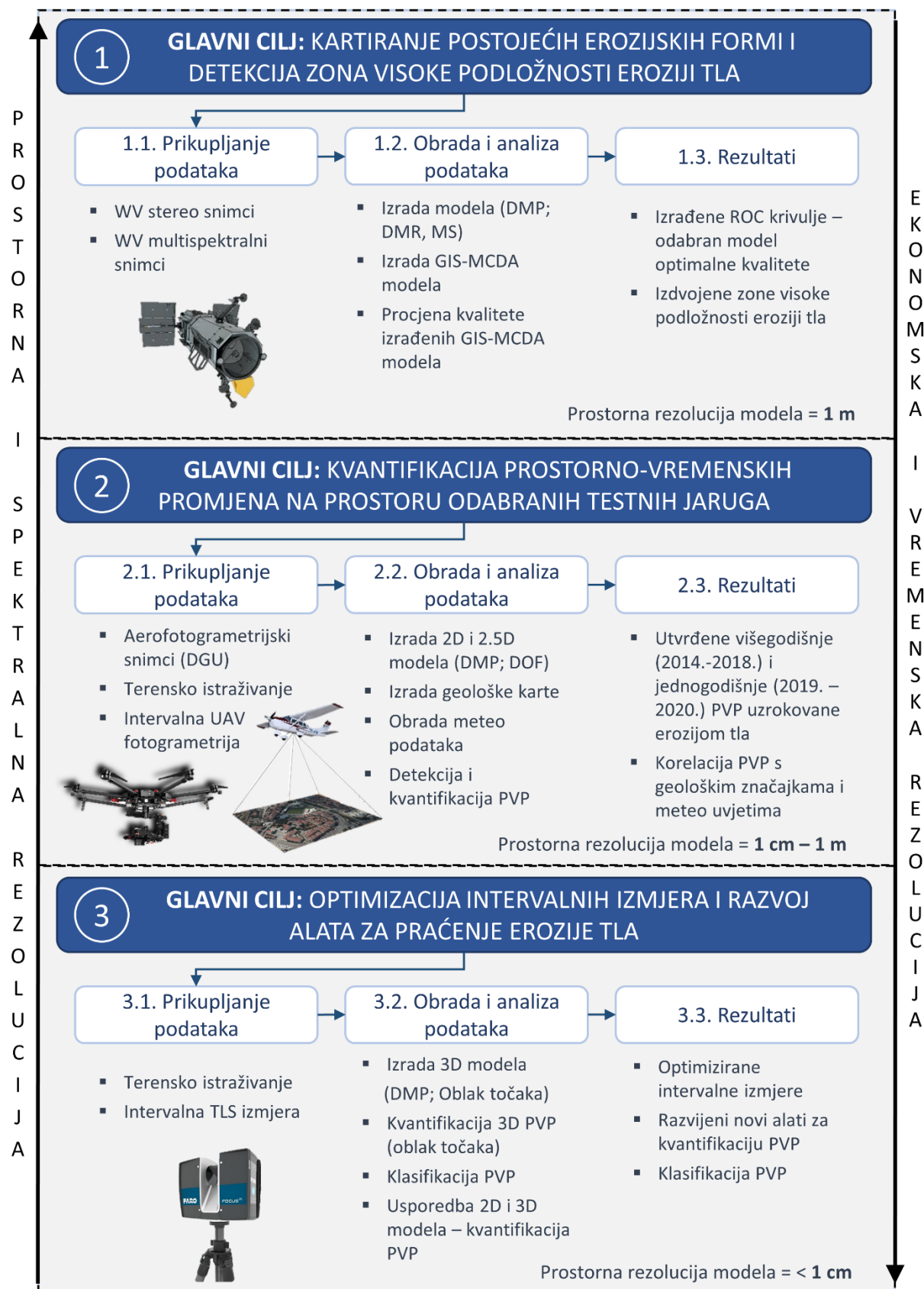
Slika 22. Metodološki okvir višerezolucijskog pristupa proučavanju erozije tla zasnovanom na korištenju makro (1), mezo (2) i mikro (3) razine istraživanja
