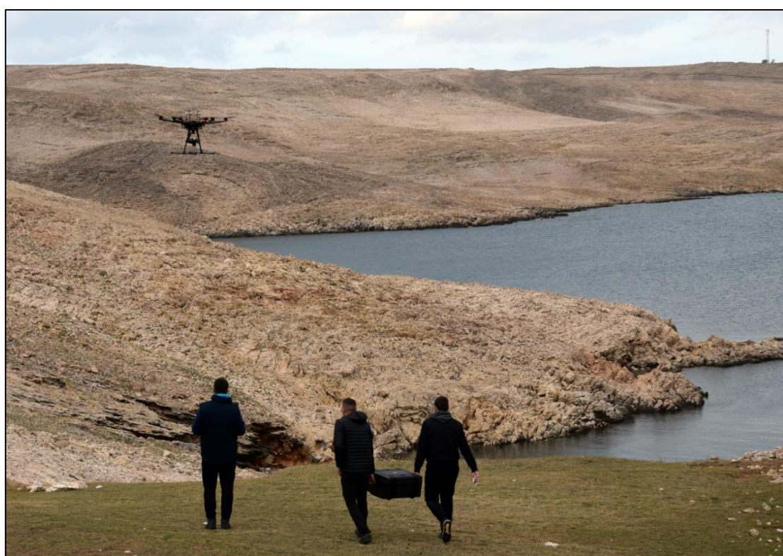
Slika 62. Inicijalno aerofotogrametrijsko snimanje jaruge Santiš s razvijenim RAPS sustavom
