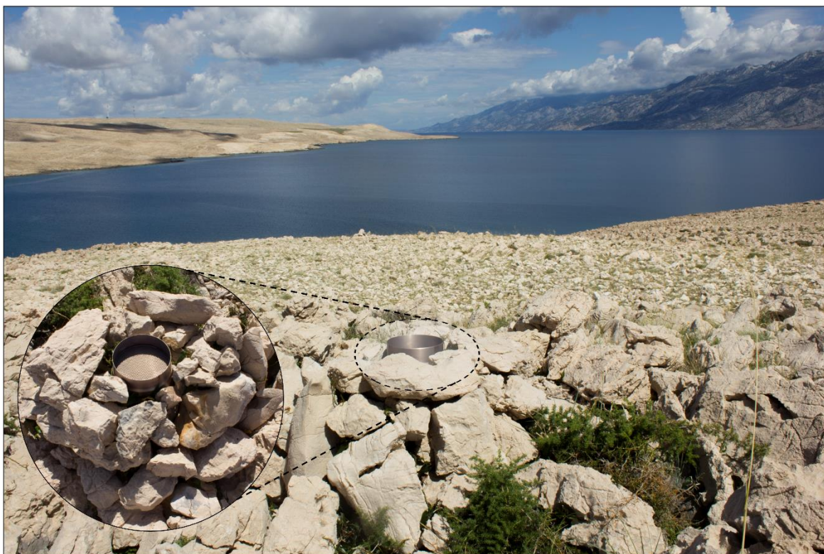
Slika 67. Jedan od dva Hobo Onset RG3-M uređaja postavljena nedaleko od jaruge Santiš Prikupljanje podataka o temperaturi zraka
