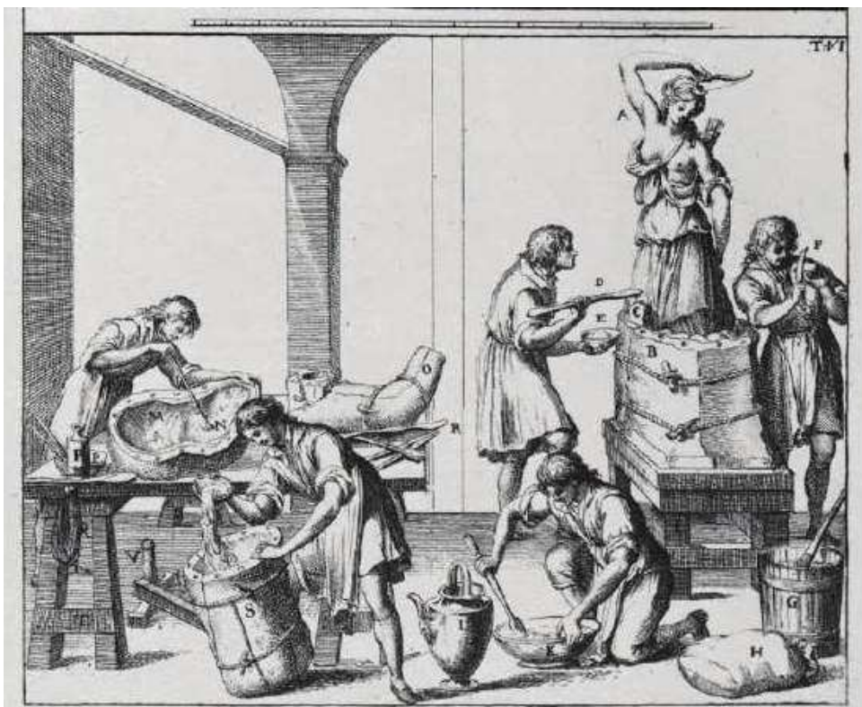
Sl. 5. Demonstracija izrade odljeva i potreban alat, Francesco Carradori, Istruzione Elementare per gli Studiosi della Scultura , Firenca, 1802., pl. VI.
