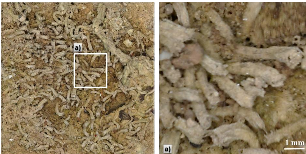
Slika 187. PL16 (ožujak, 2019) inkrustacija cilindričnih cijevi
