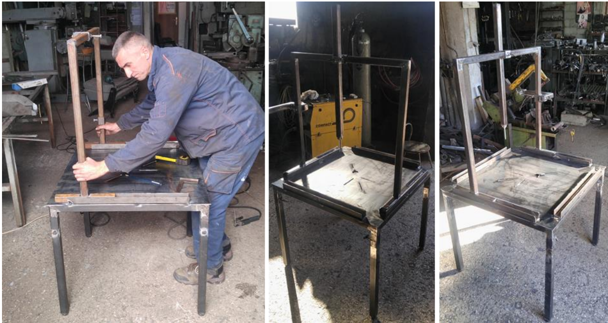
Slika 72. Proces izrade mehaničkog okvira CMD-a
