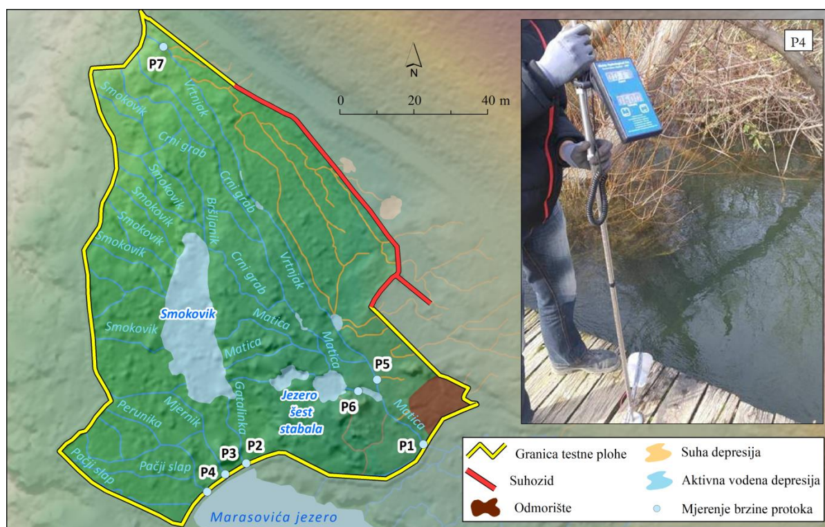
Slika 59. Lokacije mjerenja protoka vode na testnoj plohi
