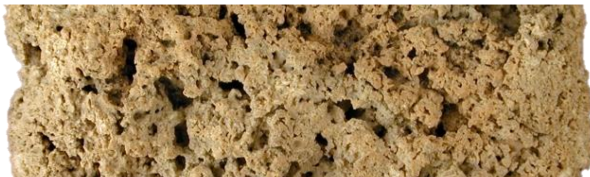
Slika 11. Šupljikava struktura sedre
