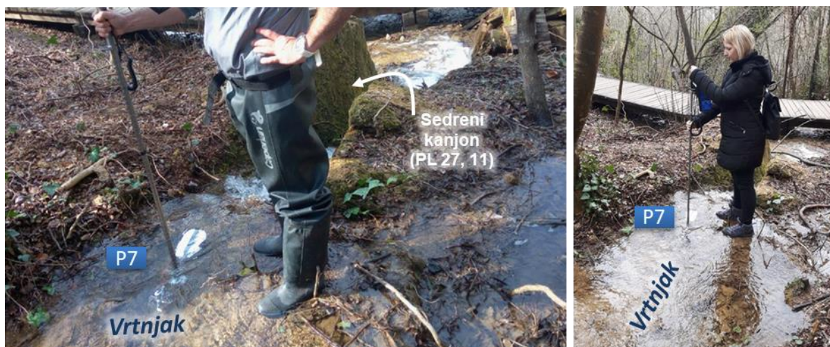
Slika 63. Mjerenje brzine protoka vode na lokaciji P7 (najnižvodnija točka toka Vrtnjak na testnoj plohi)
