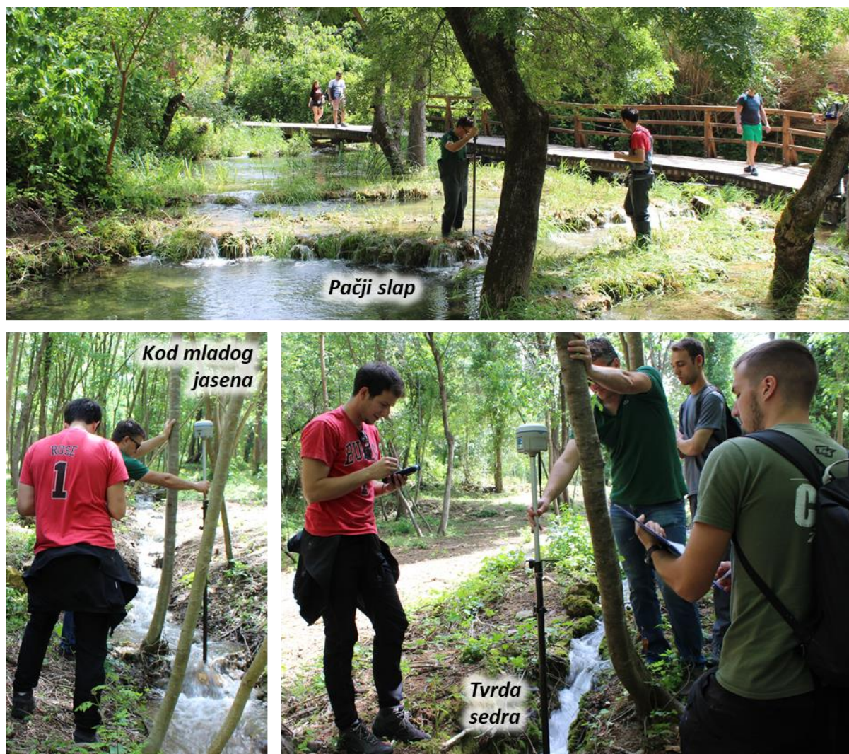
Slika 81. Prikupljanje lokacija pločica RTK-GPS-om
