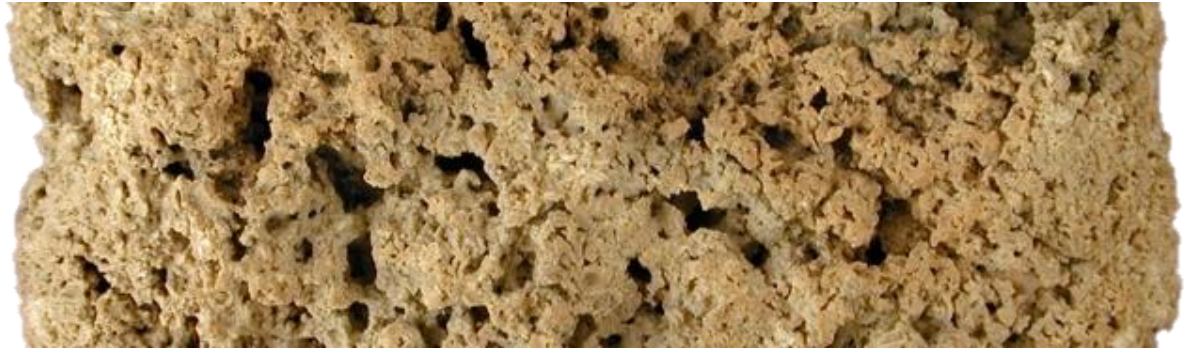
Slika 11. Šupljikava struktura sedre
