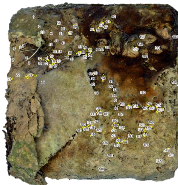
Slika 199. Detektirani mikroorganizmi na površini PL10 (ožujak, 2019)
