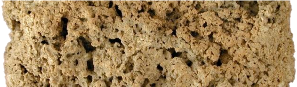
Slika 11. Šupljikava struktura sedre
